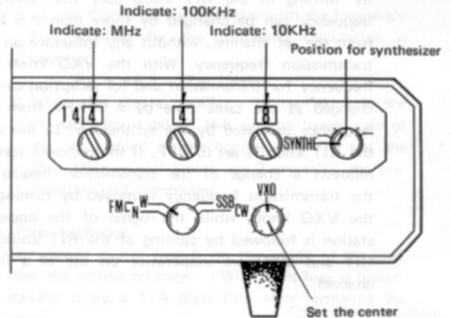
HOW TO READ THE FREQUENCY (Fig. 144.480MHz)
